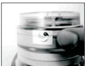
3.4 В случае замены счетчика модуль Residia-M должен быть снят со старого счетчика и установлен на новый в соответствии с п.п. 3.1...3.2.
