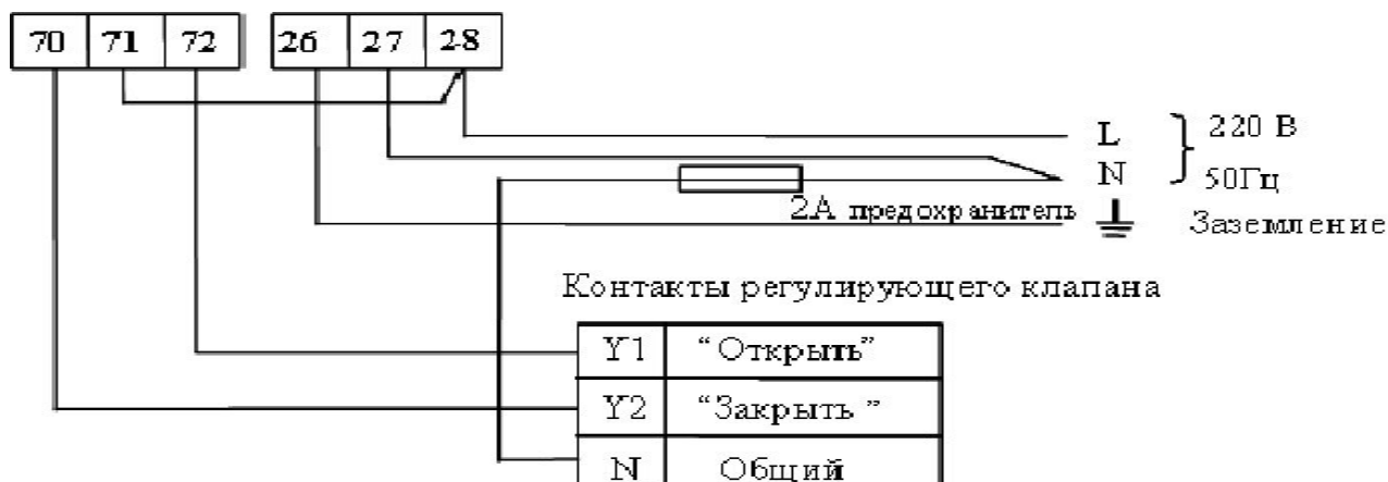
Рис.В2. Схема подключения сервопривода (для выполнения функции регулирования) и сетевого питания (напряжение сервопривода 220 В).
