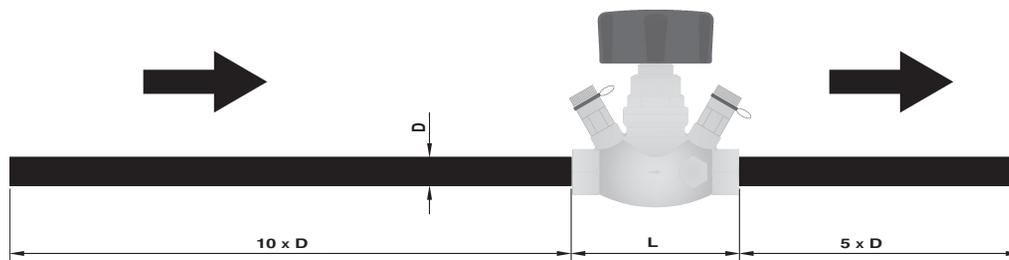
В системах с морозозащитой необходимо учитывать поправочный коэффициент. Вязкость водно-гликолевой смеси отличается от вязкости чистой воды. Кроме того, данная смесь является температурозависимой. Поэтому при измерениях посредством измерительного компьютера отображаемый результат измерения будет неверным.
