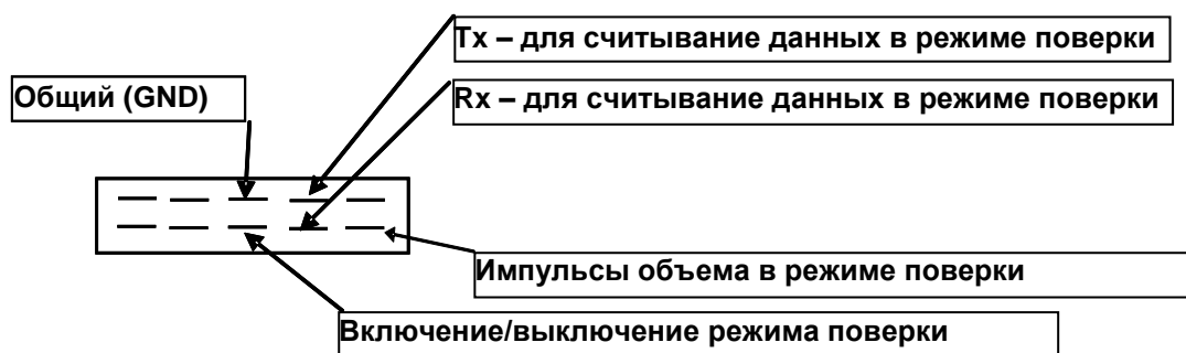
Рис.6.3. Назначение контактов разъема J
